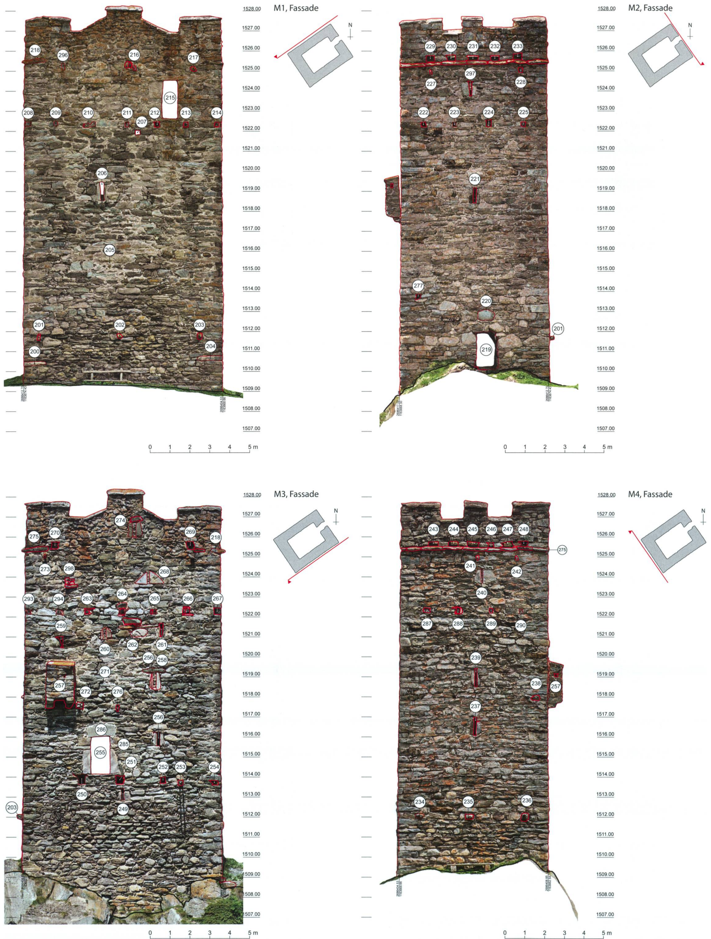
21: Hospental UR, Turm 2021/22. Befundkartierung der vier Innenwände.
