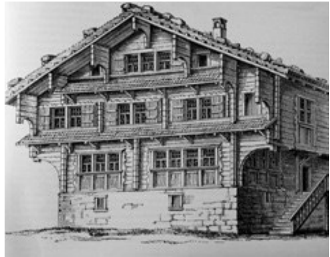
Abb. 5. Wolfenschiessen NW, Grosssitz, um 1600. Ein «typisches» Unterwaldner Haus (Huwyler 1930). Links die überkragende Kammer des zweiten Vollgeschosses. Nach Huwyler 1993, 381.
