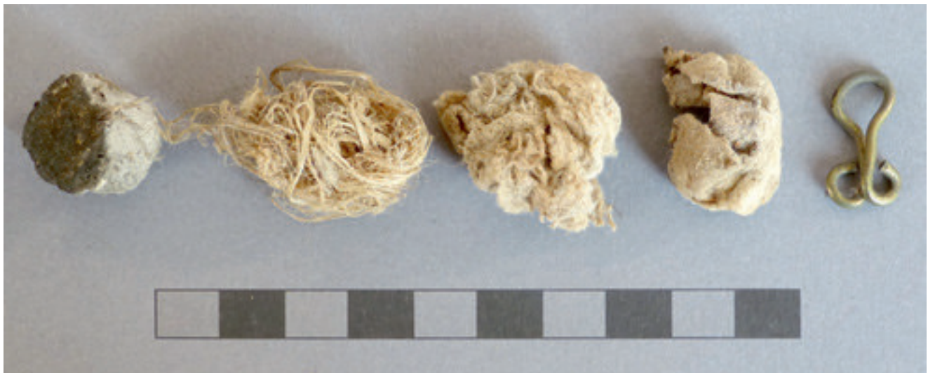
Abb. 2. Schwyz SZ, Gütschweg 11 (1311d). Grosse Stube, Nordwand. Verpflockung: Mörtelpfropfen, Faserwerk (Lein oder Hanf), zwei Gewebefragmente in Leinwandbindung, Gewandöse (von links nach rechts, entsprechend von aussen nach innen). Foto BAB Gollnick, U. Gollnick.
